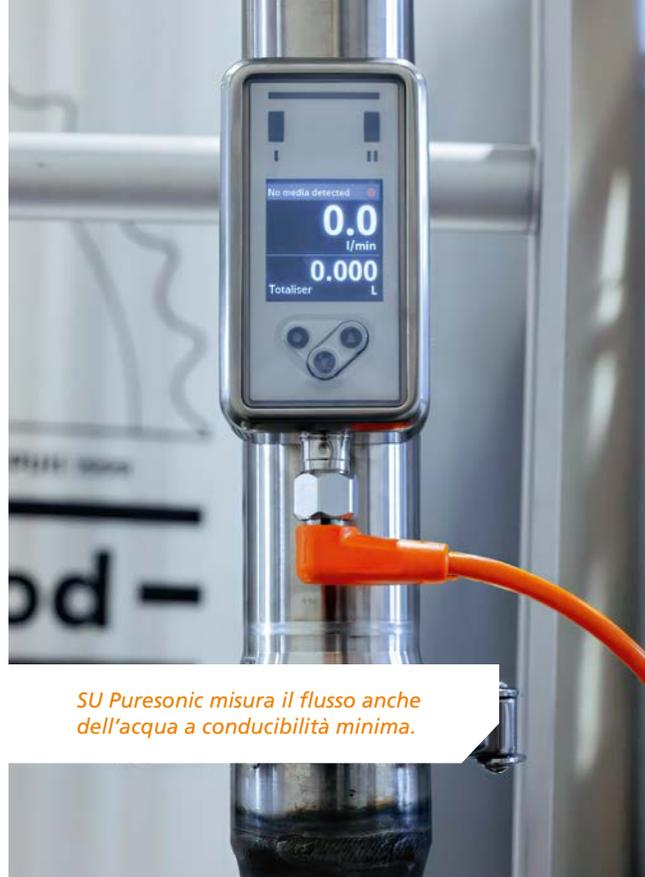
*SU Puresonic misura il flusso anche dell'acqua a conducibilità minima.*
