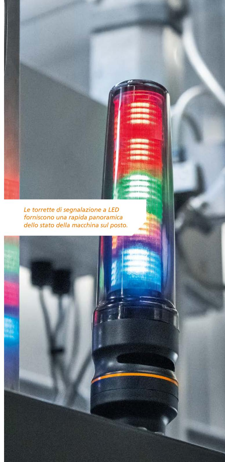
*Le torrette di segnalazione a LED forniscono una rapida panoramica dello stato della macchina sul posto.*
