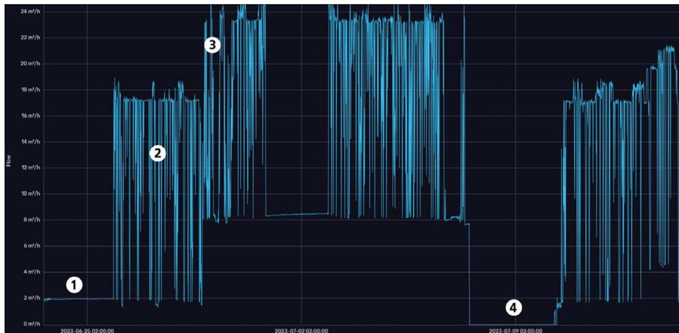
Preziosi approfondimenti sulla rete dell'aria compressa. Chiaramente riconoscibile: il consumo di base (1) e il consumo di produzione (2) aumentano significativamente in seguito ad una perdita (3). Una volta eliminata la perdita, il consumo di base scende quasi a zero (4).
