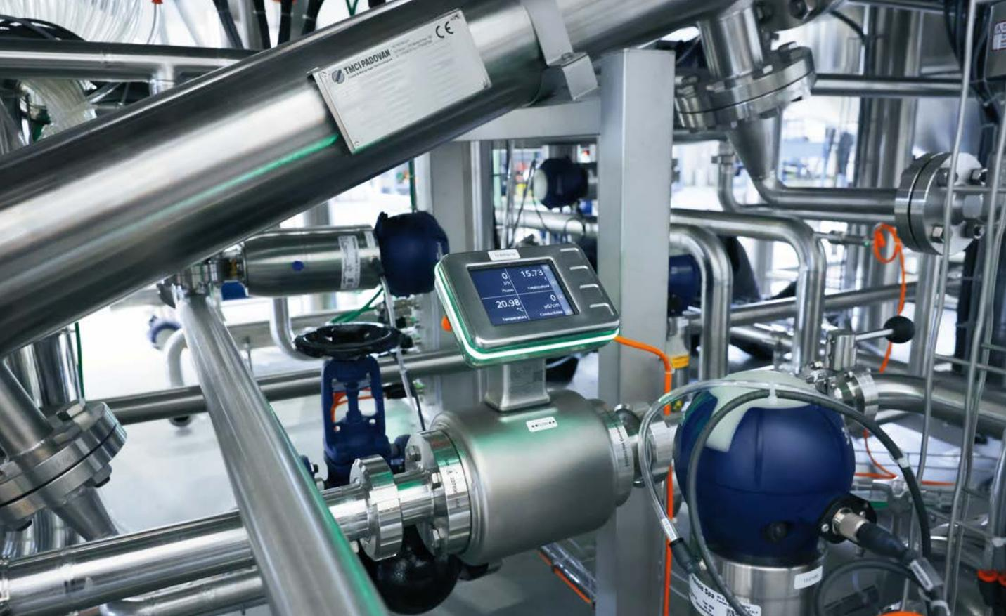
*SM Foodmag rileva tre importanti variabili in un unico punto di misura: flusso, conducibilità e temperatura.*
