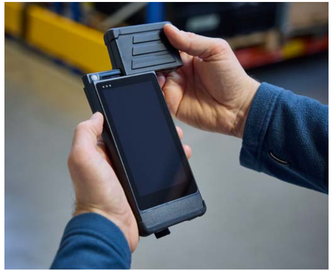
I vari moduli antenna sul bordo superiore del lettore portatile possono essere facilmente sostituiti.
