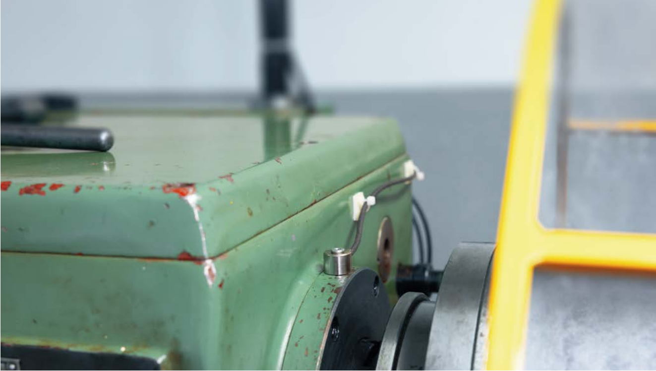
機器的「耳朵」：VSA005 震動傳感器可捕捉機器驅動器中所有滾動軸承的振動頻譜。
