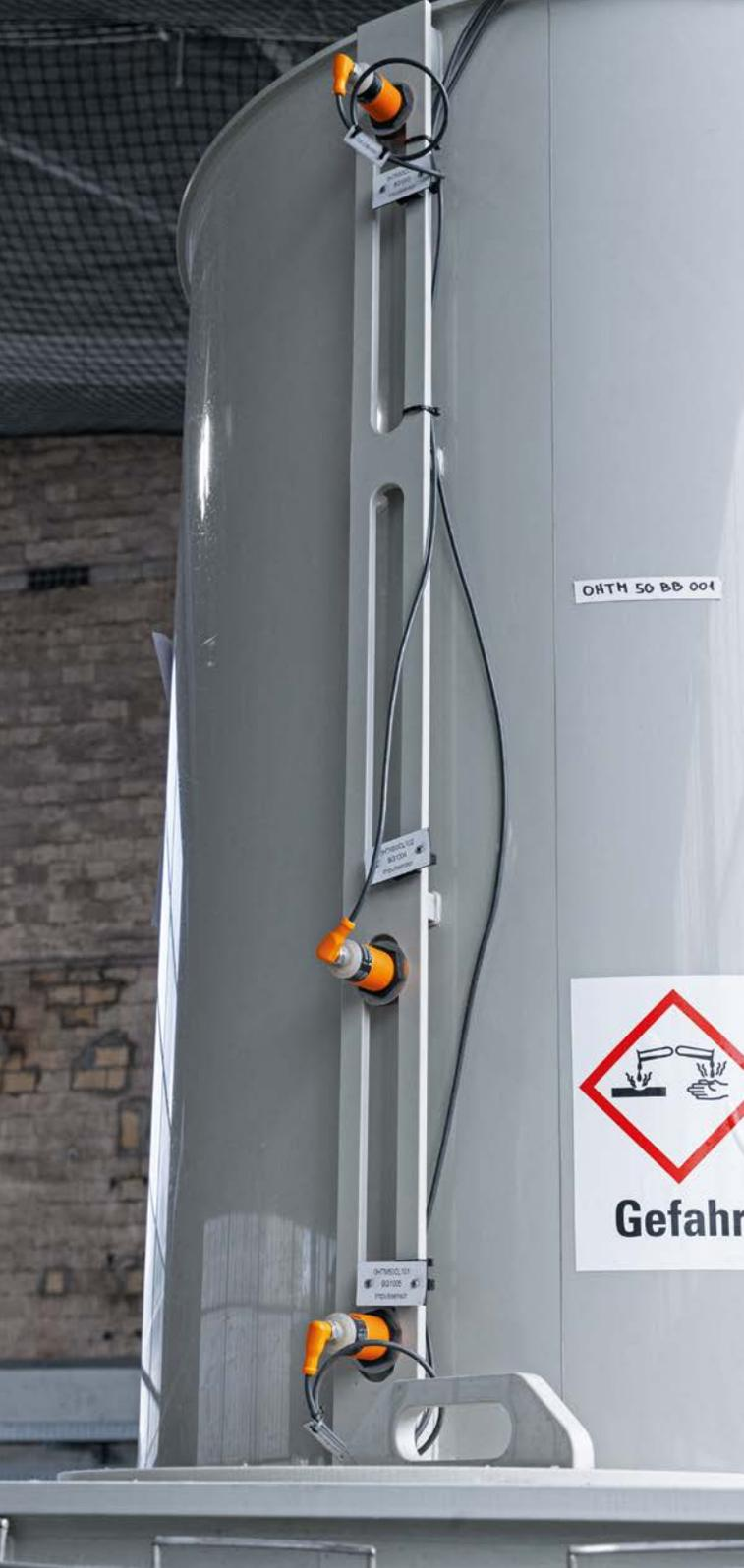
„Am Filterautomaten unterstützen zahlreiche ifm-Sensoren sowohl den optimalen Prozessablauf als auch das Energiemanagement.“
