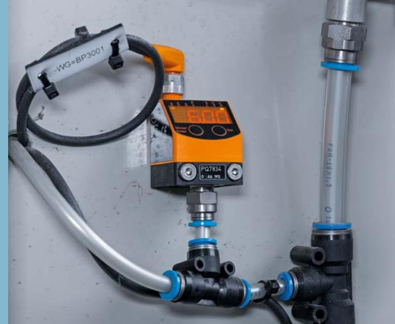
**Ein Drucksensor der Baureihe PQ überwacht die Druckluft, die zum Schalten der Ventile benötigt wird.**
