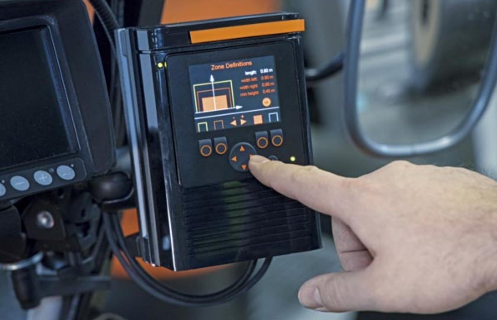
*In einer erweiterten Parametrierung lassen sich verschiedene Warnzonen festlegen, die bestimmte Ausgangssignale schalten.*
