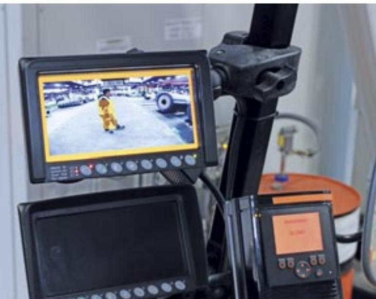
Auf dem Monitor sieht der Fahrer den Rückbereich des Staplers. Farblich abgestufte Rahmen markieren das Objekt im Fahrweg und lösen weitere Warnsignale bis hin zum Not-Stopp aus.
