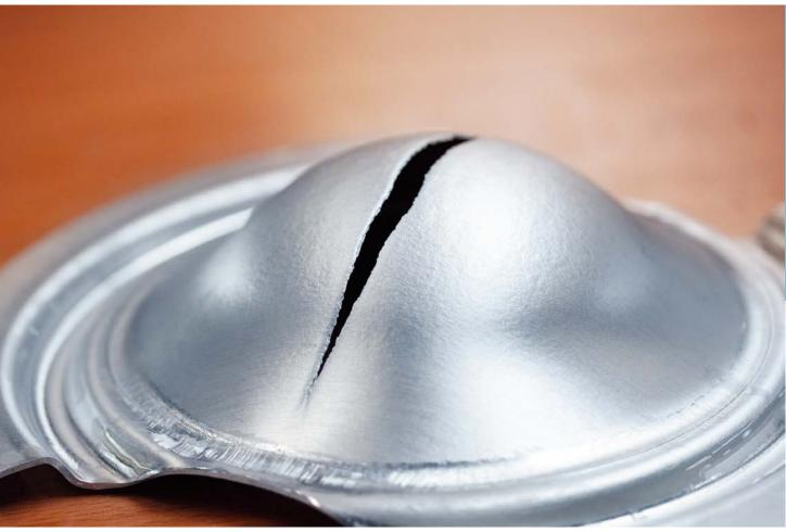
中島法による成形限界試験後に割れが発生した試料。材料の成形限界を取得することにより、自動車部品に適しているかなどを判断できます。
