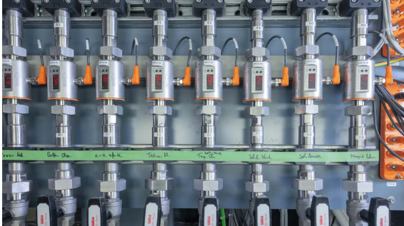
Sensores de vazão monitoram o circuito de refrigeração do módulo Czocharski.
