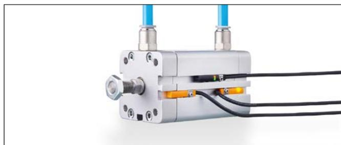
**一体两用：**在短行程气缸中，现在使用1个IO-Link气缸传感器（上槽）就足以检测两个末端位置，而无需像过去一样使用2个常规传感器（下槽）。
