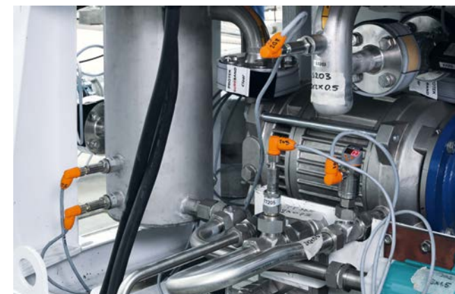
O processo complexo é monitorado de perto com vários sensores para obter a melhor eficiência possível.
