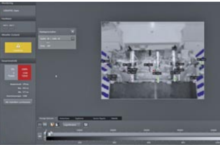
ifm-VisionAssistant zur Parametrierung und Visualisierung der O3D-Kamera.
