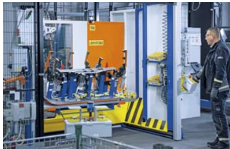
In der Schweißanlage werden mehrere vorbearbeitete Bleche zu einem Unterassemble verschweißt.
