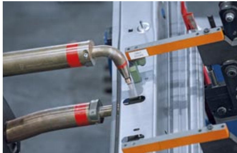
Freier Bauraum: Im Bereich der Schweißzangen und Schweißspritzer sind keine Sensoren mehr erforderlich.
