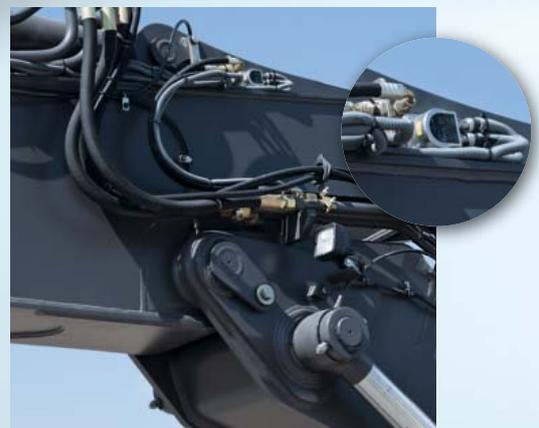
*Sulle macchine mobili, i sensori di inclinazione vengono utilizzati per rilevare l'angolo e la posizione. Consentono un livellamento esatto di gru mobili o escavatori.*
