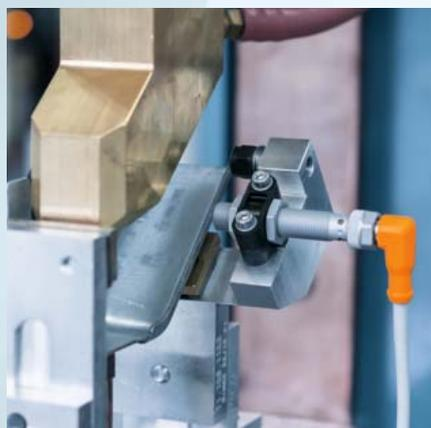
*I prodotti ecolink EVW sono ideali per l'utilizzo in applicazioni di saldatura. Il rivestimento antiaderente del cavo PUR e del dado del raccordo impedisce l'adesione dei lapilli di saldatura.*
