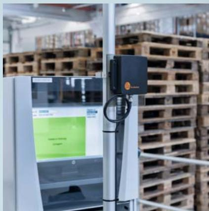
*Le soluzioni RFID nel campo UHF vengono utilizzate nella produzione, nell'intralogistica e nei sistemi di movimentazione. Le portate elevate e la capacità di leggere contemporaneamente più TAG sono vantaggi decisivi.*
