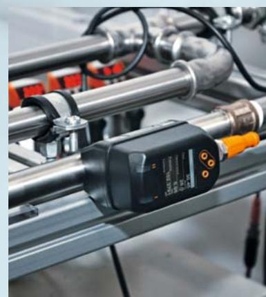
I sistemi per il monitoraggio delle vibrazioni servono per una manutenzione condizionale della macchina. Segnalano tempestivamente possibili e costosi danni ai cuscinetti, ad es. su ventilatori e consentono di pianificare un'eventuale sostituzione.
