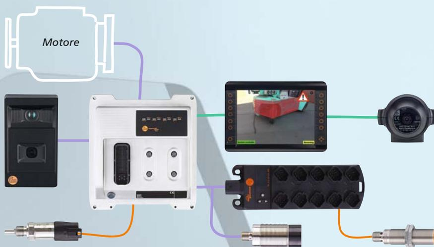
*Il sistema ecomatmobile offre la massima affidabilità. L'elemento centrale del sistema è ecomatController, un controller potente e sicuro con certificazione E1.*
