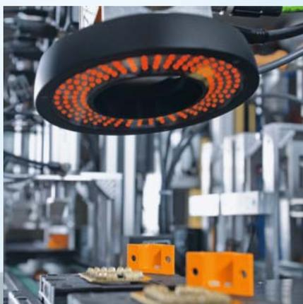
*I sensori di rilevamento oggetti con rilevamento del contorno indipendente dall'orientamento, ad es. O2D, eseguono funzioni quali il controllo della presenza, della posizione e della qualità, ma anche funzioni di selezione e conteggio.*
