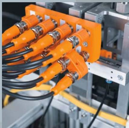
*I moduli I/O decentralizzati, completamente resinati, collegano sensori e attuatori al gateway o PLC tramite AS-i. Il loro utilizzo vicino all'attuatore incrementa anche l'efficienza energetica.*
