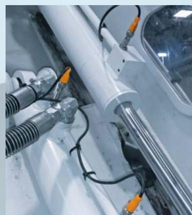
*I sensori di ifm per macchine mobili sono caratterizzati da un'elevata resistenza a urti e vibrazioni, un campo ampliato della temperatura di esercizio, alto grado di protezione ed elevata resistenza EMC.*
