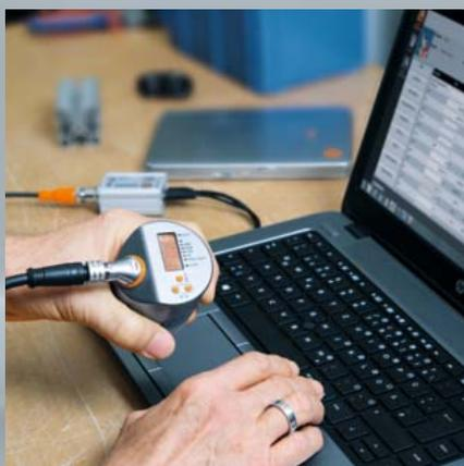
*I sensori e gli attuatori con interfaccia IO-Link vengono configurati e visualizzati, online e offline, con il software LR DEVICE.*
