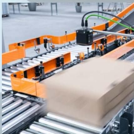
*Il sensore O3D non controlla soltanto la completezza. Anche la dimensione, l'orientamento e la posizione, ad es. dei colli, vengono rilevati in modo rapido e il volume dello spazio di stoccaggio viene così utilizzato in maniera ottimale.*
