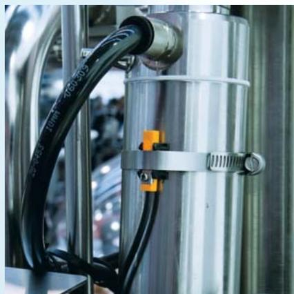
*Gli adattatori e i sistemi di fissaggio consentono un montaggio rapido e sicuro dei sensori.*
