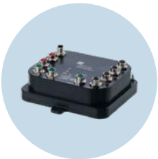
Chẩn đoán rung Thiết bị điện tử chẩn đoán cho sử dụng phân tán
