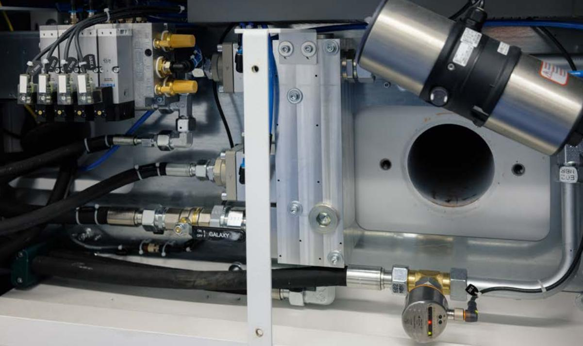
*Il flussostato rileva la velocità con cui il refrigerante viene immesso nel processo di rettifica. La barra LED indica il comportamento del flusso.*
