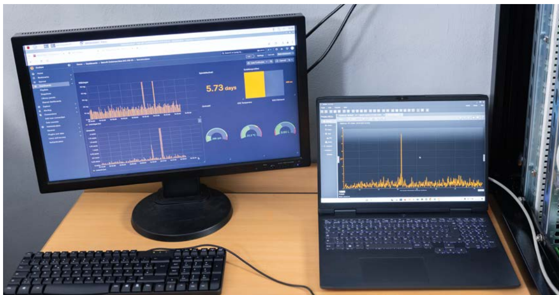
Betriebs- und Schwingungsdaten lassen sich übersichtlich darstellen. Bei Überschreitung von Grenzwerten wird eine Alarmmeldung ausgegeben.
