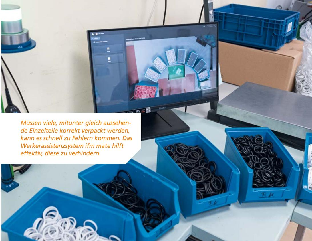
Müssen viele, mitunter gleich aussehende Einzelteile korrekt verpackt werden, kann es schnell zu Fehlern kommen. Das Werkerassistenzsystem ifm mate hilft effektiv, diese zu verhindern.
