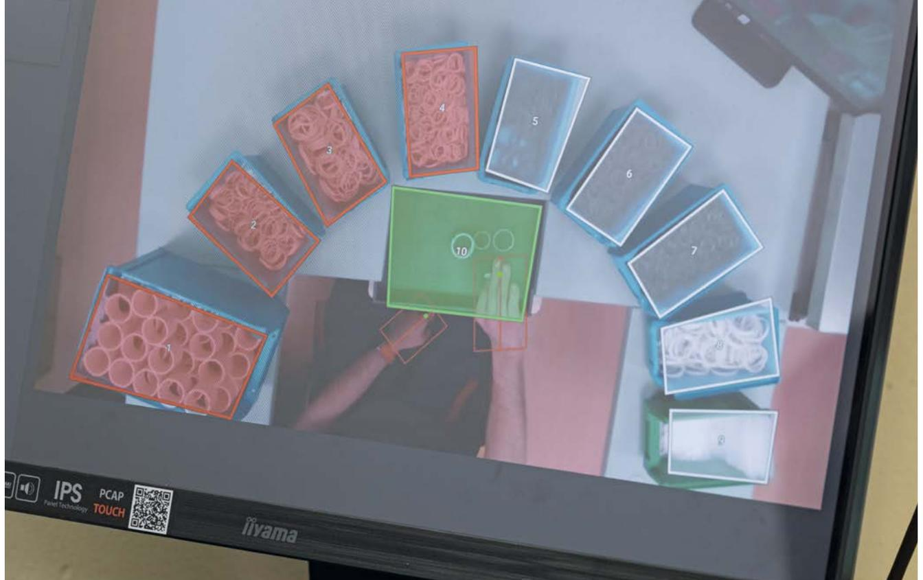
Der Worker wird per Display durch den Verpackungsprozess geführt. Die Software verarbeitet Position, Ausrichtung und Höhe der Hand und kann so die korrekte Ausführung der einzelnen Schritte sicherstellen. Die Farbgebung zur optischen Orientierung für den Worker ist frei definierbar.
