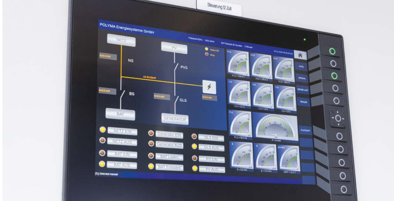
Das zentrale ifm-Touch-Display CR1204 dient sowohl zur Visualisierung sämtlicher Betriebsparameter als auch zur Einstellung der verschiedensten Funktionen.
