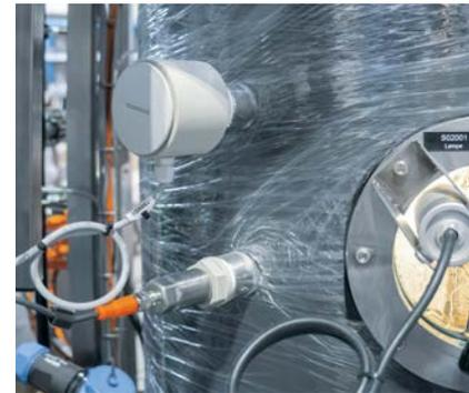
**Füllstandsensor Typ LMT**
