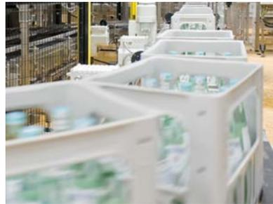
Vollkastenkontrolle – die automatische Positions- und Drehlagenachführung garantiert eine stabile Funktion auch bei variabler Objektposition.
