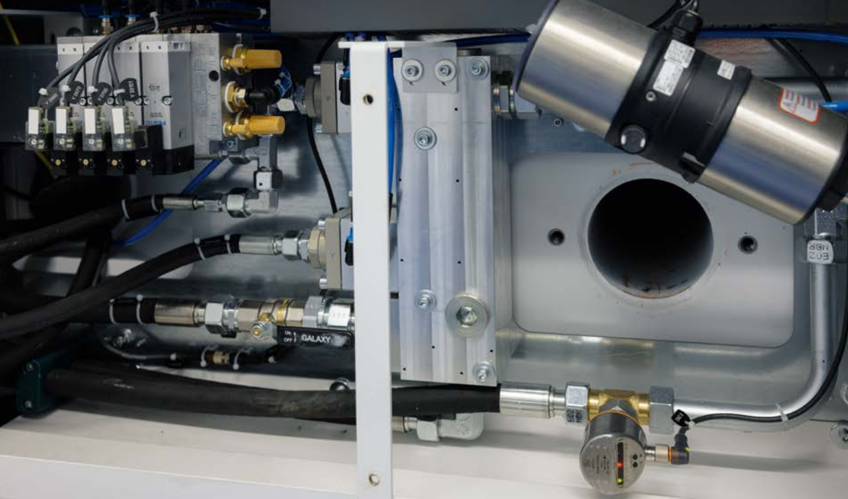
流量監控器記錄冷卻液供給至磨削製程的速度。LED 長條圖顯示流量狀況。
