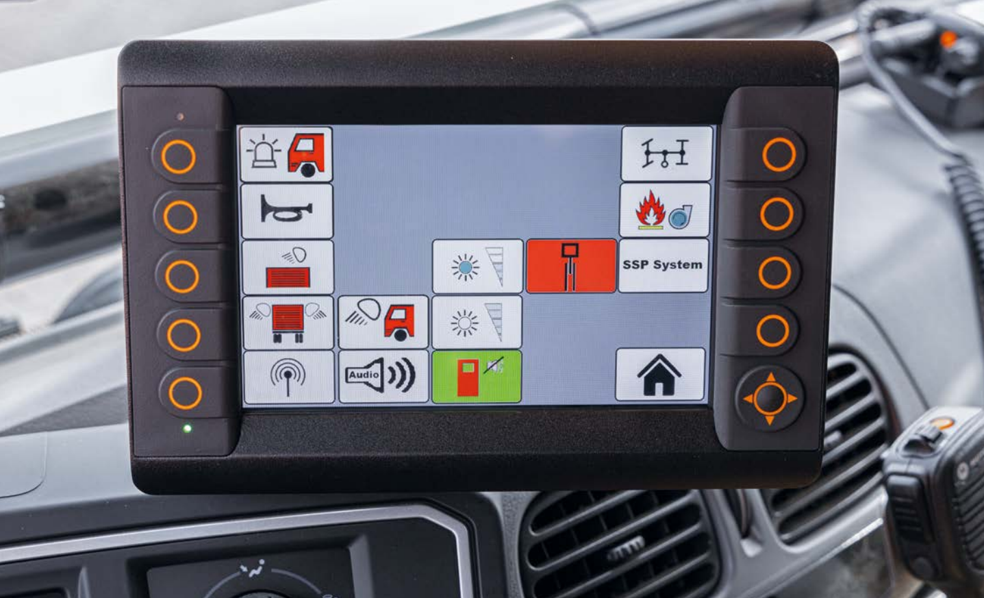
駕駛員可透過駕駛艙中的 CR1082 可程式化圖形顯示器控制所有專門功能並彙總。
