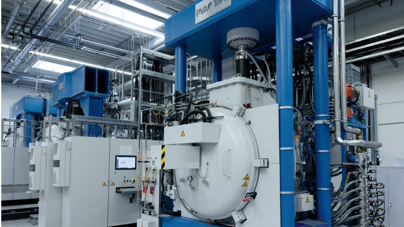
En esta máquina, se funden a alta presión unas capas con otras hasta convertirse en una única pieza.
