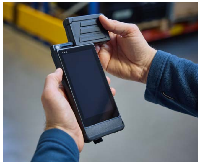
Les différents modules d'antenne sur le bord supérieur de l'appareil portable peuvent être facilement remplacés.
