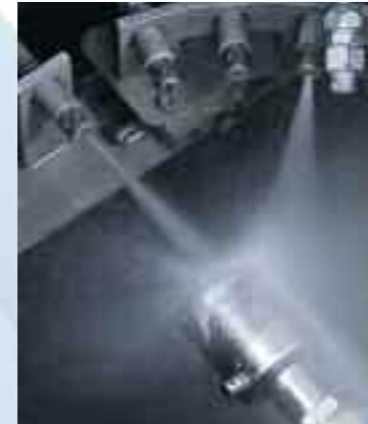
Dicht unter extremen Bedingungen: Test für die Schutzart IP 69K.
