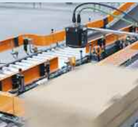
Schwergewicht in der Logistik: 3D-Sensoren vermessen Pakete zur Berechnung des Volumengewichts.
