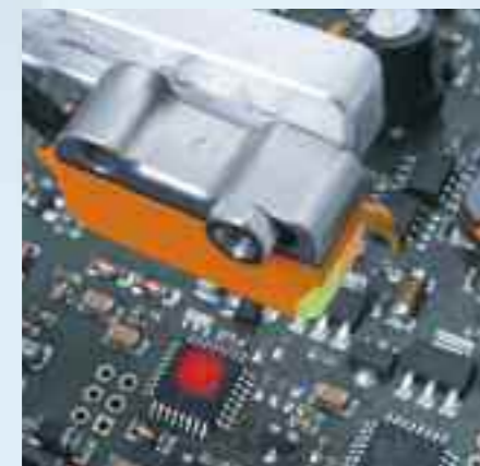
Optischen Sensoren entgeht nichts: Kleinste, schmale und flache Bauteile, auch mit dunklen oder glänzenden Oberflächen, werden erkannt.
