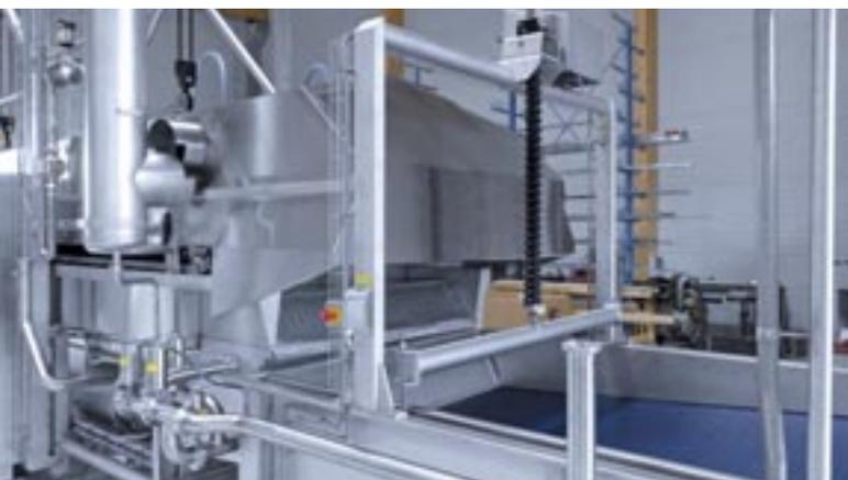
Das Kühlband kann zur Reinigung per Seilzug angehoben werden. Induktive Sensoren überwachen die jeweiligen Endpositionen oben und unten.
