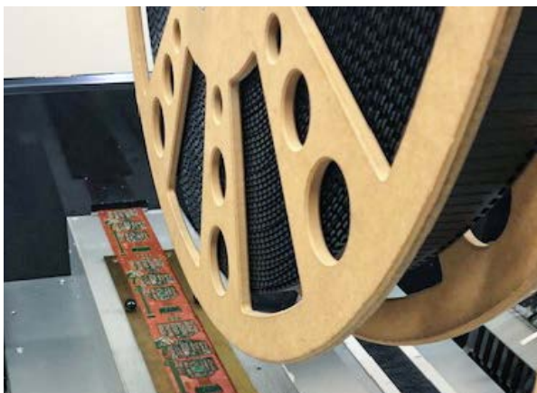
Rolle-zu-Rolle-Prozess zur Herstellung des flexiblen Leiterfilms
