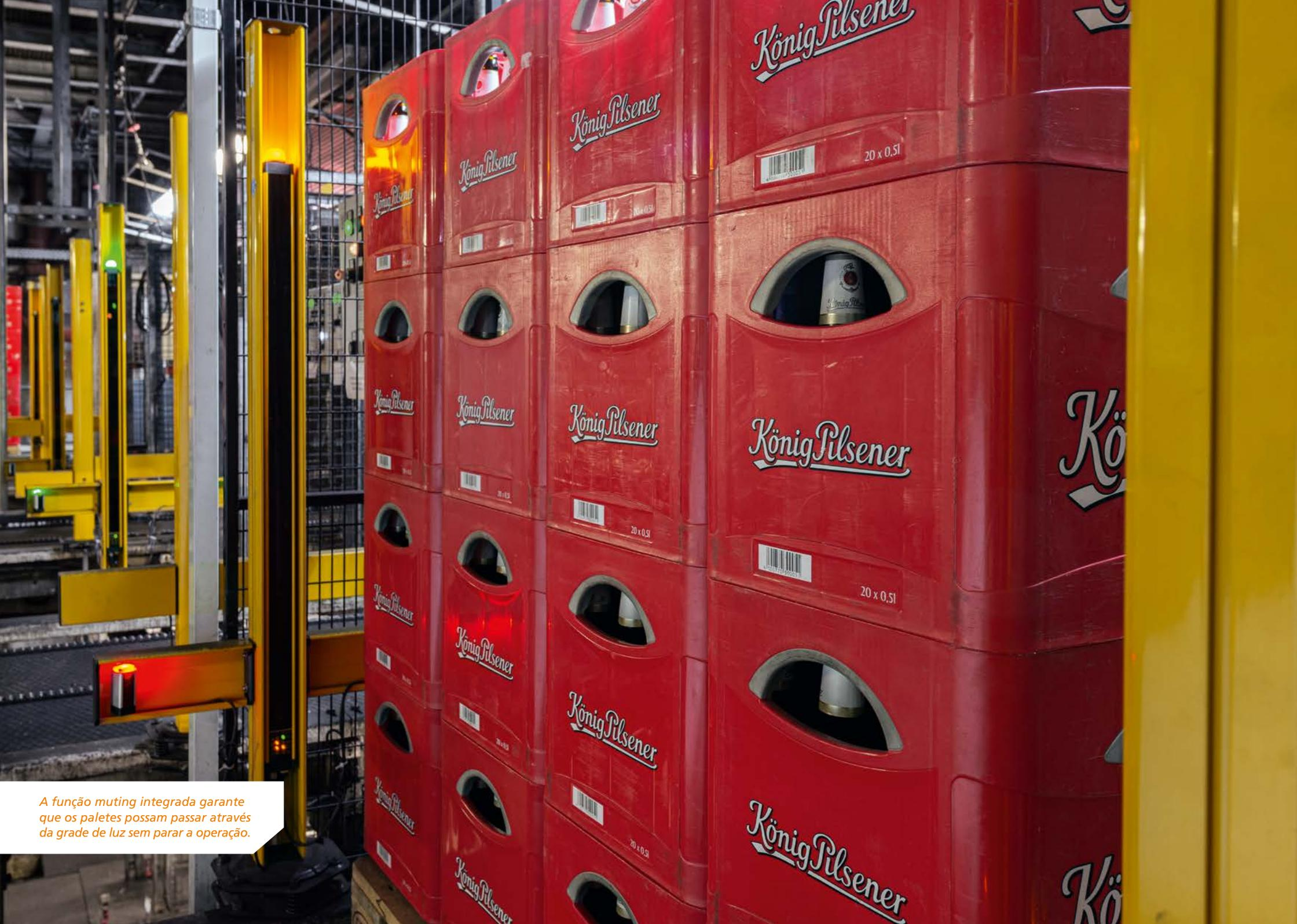
A função muting integrada garante que os paletes possam passar através da grade de luz sem parar a operação.
