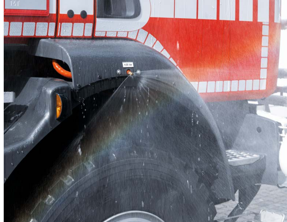
Die Selbstschutzanlage benetzt Fenster und Räder mit einem Wassersprühnebel. Damit kann das Fahrzeug im Notfall sogar durch Feuerwände fahren, um sich zu evakuieren.
