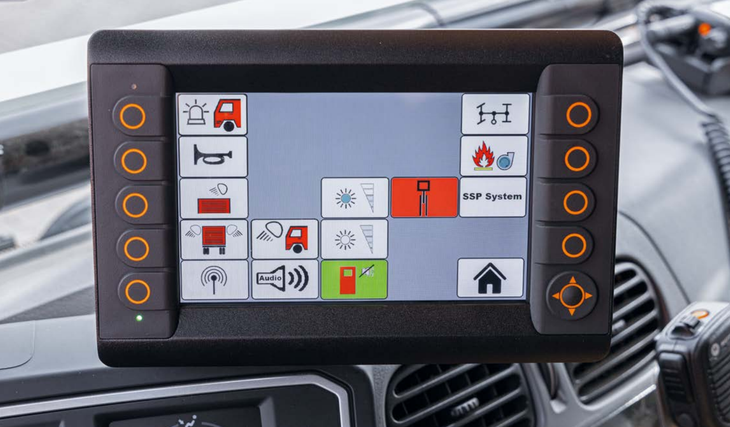
Über das programmierbare Grafikdisplay CR1082 im Cockpit kann der Fahrer sämtliche Sonderfunktionen und Aggregate ansteuern.
