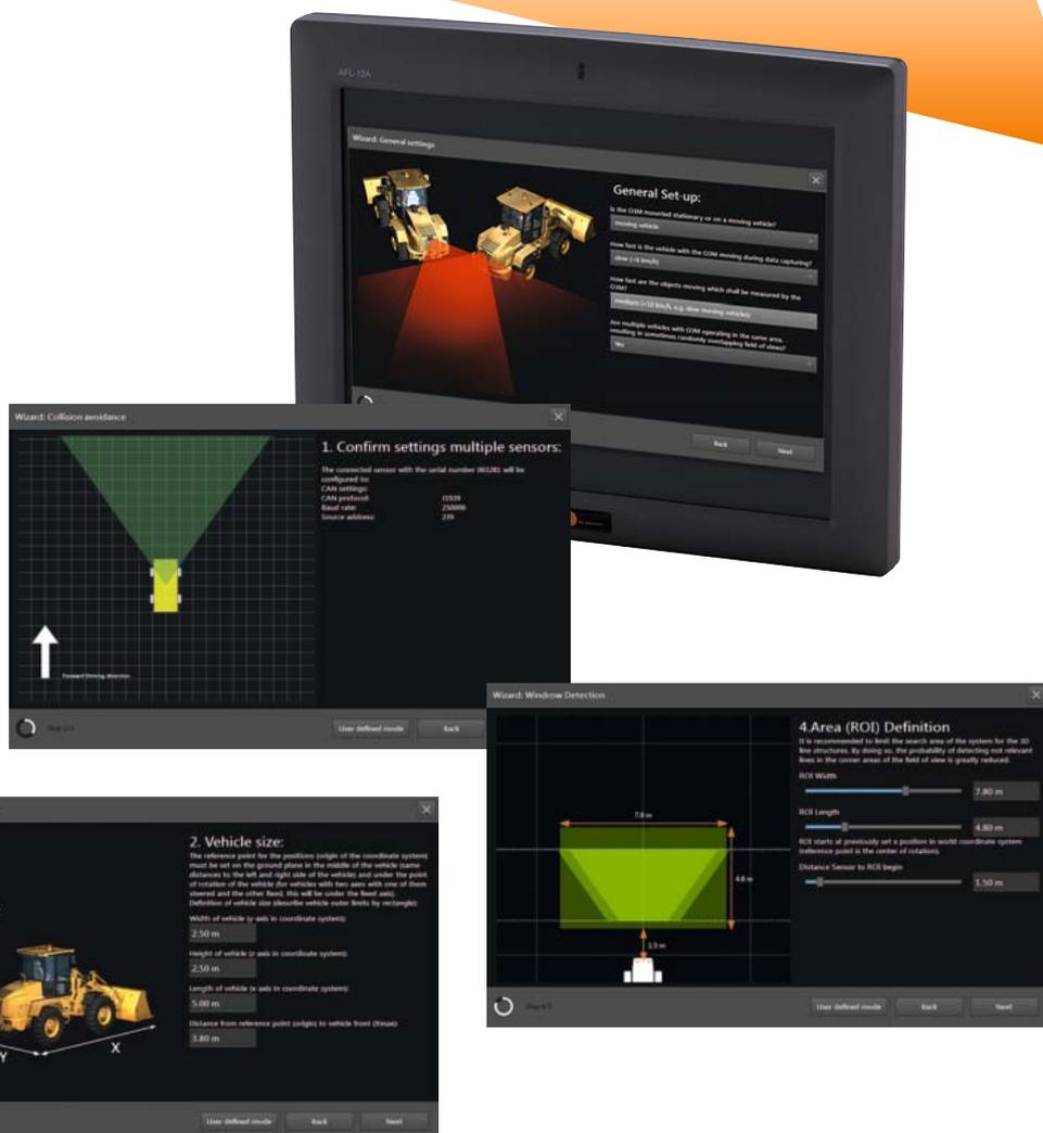
Configurazione di un sistema anticollisione
