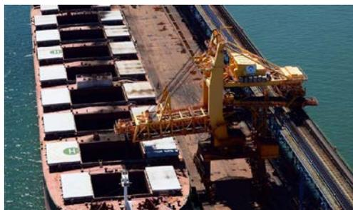
dell'intero impianto causando costi elevati. Per aumentare la disponibilità degli stacker reclaimer, le vibrazioni di motori e riduttori dovevano essere monitorate in tempo reale per consentire una rapida reazione in caso di guasto imminente.
