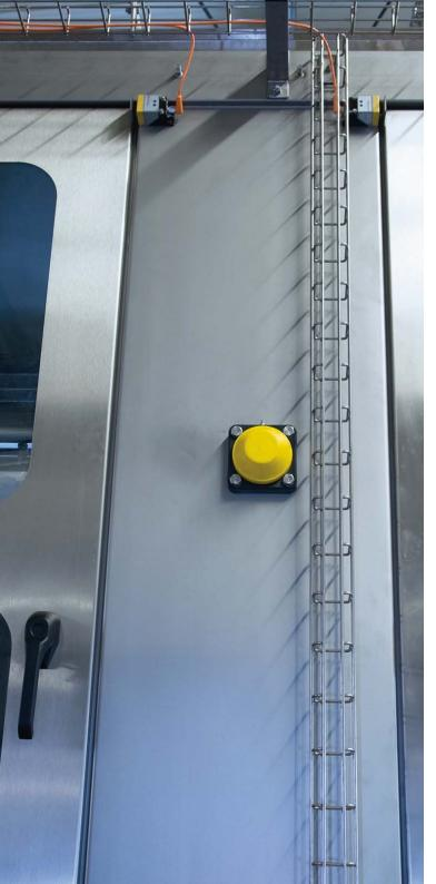
Las puertas de la instalación se supervisan con detectores inductivos de seguridad.
