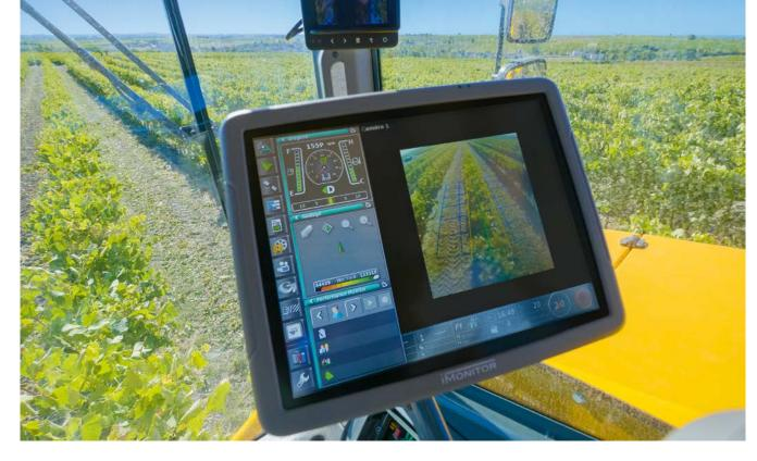
El conductor solamente controla la velocidad de trabajo; del guiado se encarga EasyPilot.
