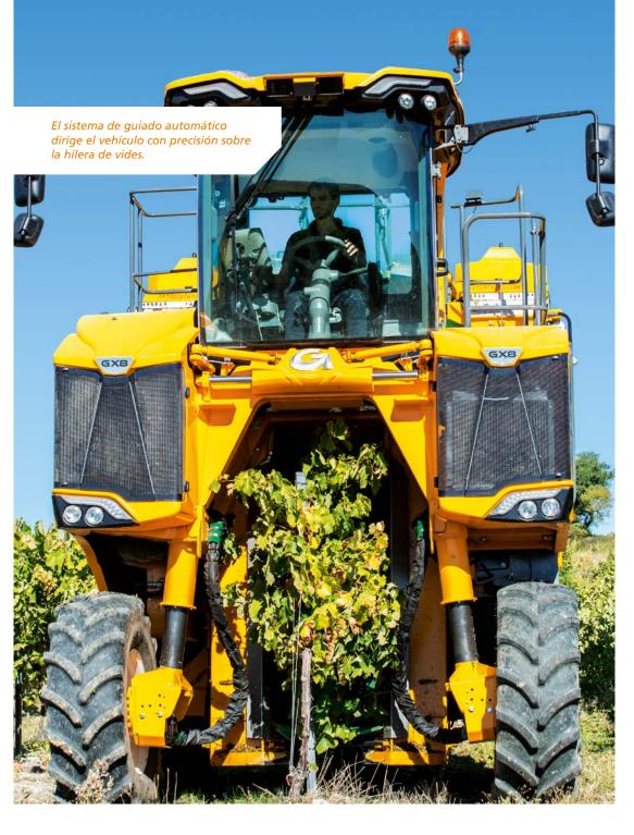
Para la detección de la hilera de vides emplea un sensor con cámara 3D (tipo O3M) de ifm. Este sensor mide la distancia hasta la superficie más próxima para cada píxel de la imagen mediante la tecnología de medición del tiempo de vuelo, registrando así el estado general de las vides. Además, permite descartar los fallos causados por hierbas altas o sarmientos que se abren hacia los lados.
