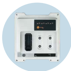
Mobilitaugliche Steuerung Sicherheitssteuerung mit CANopen-Safety
