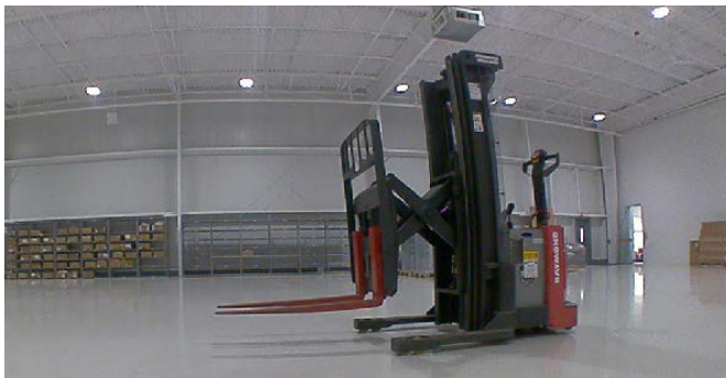
机器人平台通过2D图像和3D距离数据感知情况。
