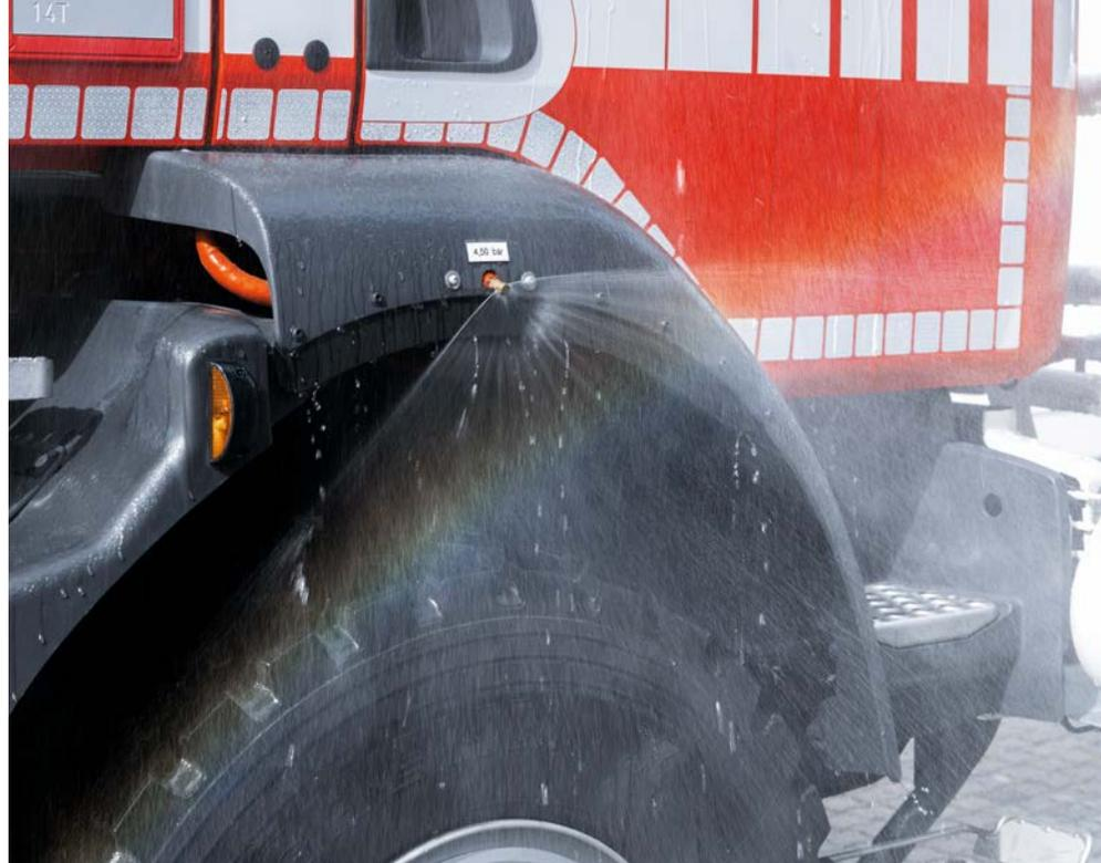
自我保护系统采用喷水器向车窗和轮胎喷水。这意味着车辆甚至可以在紧急情况下穿过火墙并自行疏散。
