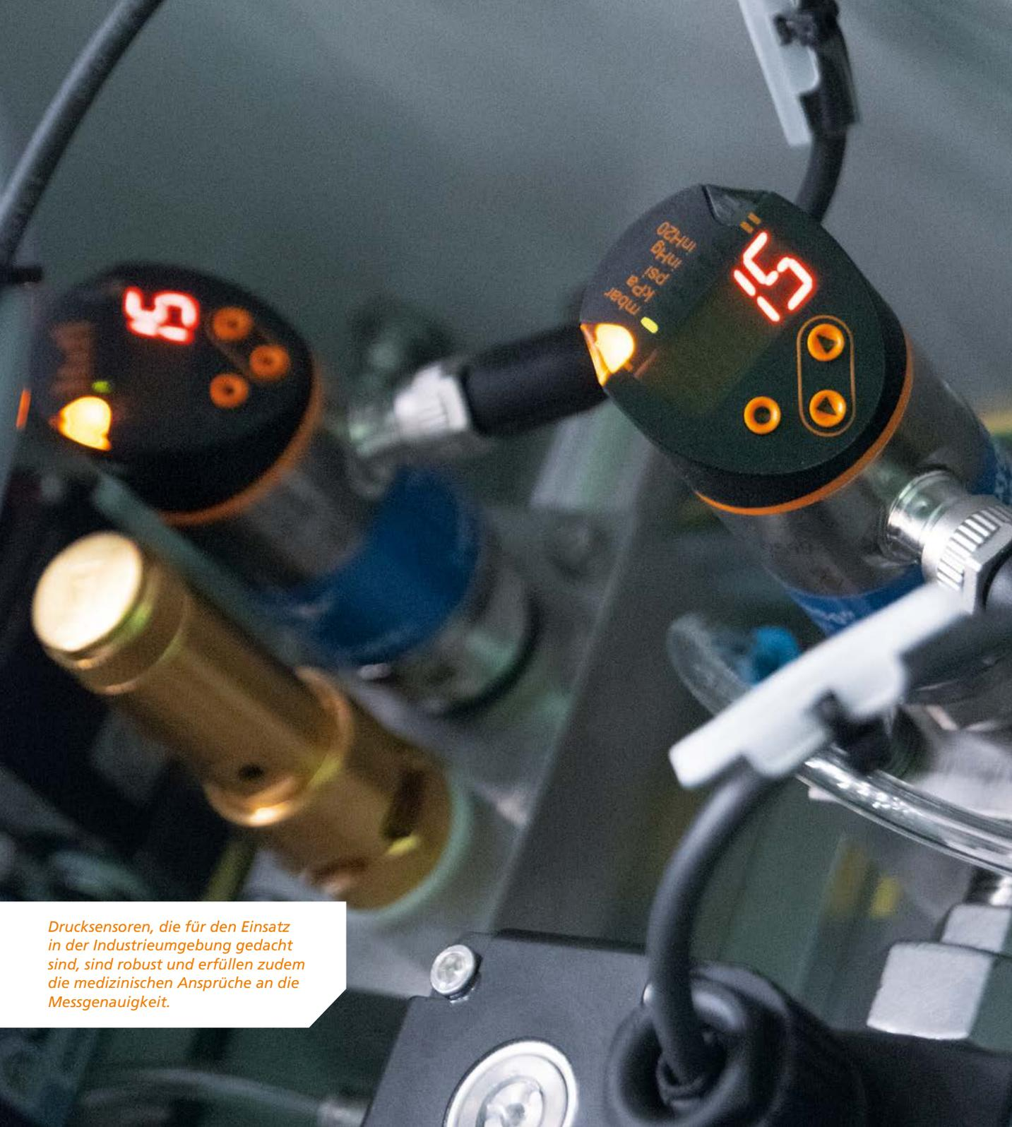
Drucksensoren, die für den Einsatz in der Industrieumgebung gedacht sind, sind robust und erfüllen zudem die medizinischen Ansprüche an die Messgenauigkeit.
