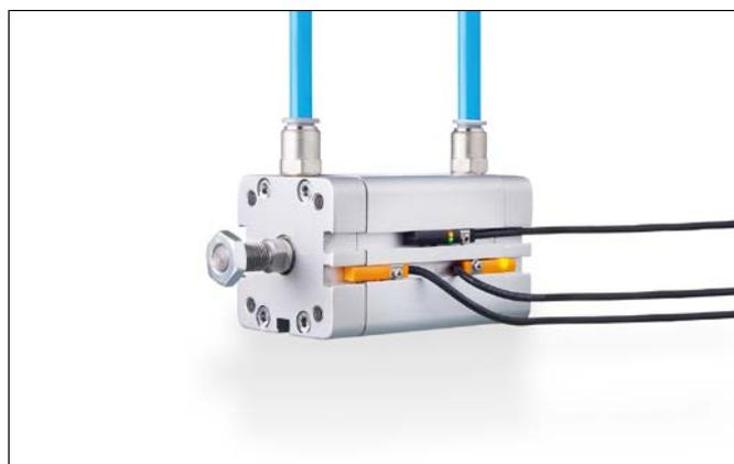
Einer statt zwei Sensoren: Am Kurzhubzylinder genügt nun ein IO-Link-Zylindersensor (obere Nut) statt wie bisher zwei herkömmliche Sensoren (untere Nut), um beide Endlagen zu erfassen.
