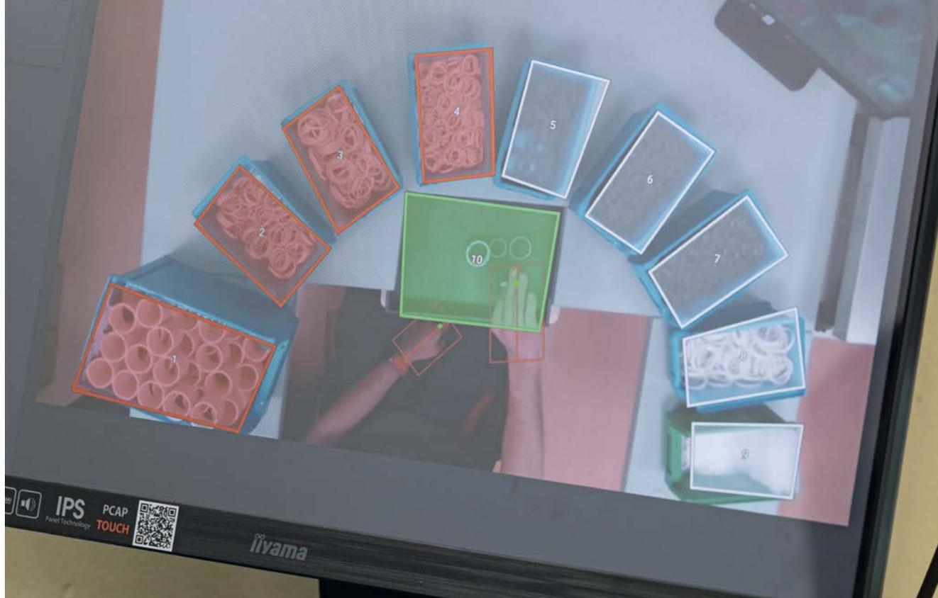
O operador é guiado pelo processo em embalagem através do display. O software processa a posição, orientação e altura da mão e pode assim garantir a correta execução de cada etapa. As cores, para orientação visual do operador podem ser definidas livremente.
