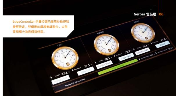
Dirk Scheffler 解釋了對 Gerber 來說很重要的另一個功能:「edgeController 是 ifm 首款配備自動化伺服器的產品。因此,如果出現任何問題,您可以透過遠端維護輕鬆存取。您所需要的只是將 EdgeController 透過乙太網路電纜連接到路由器。」
