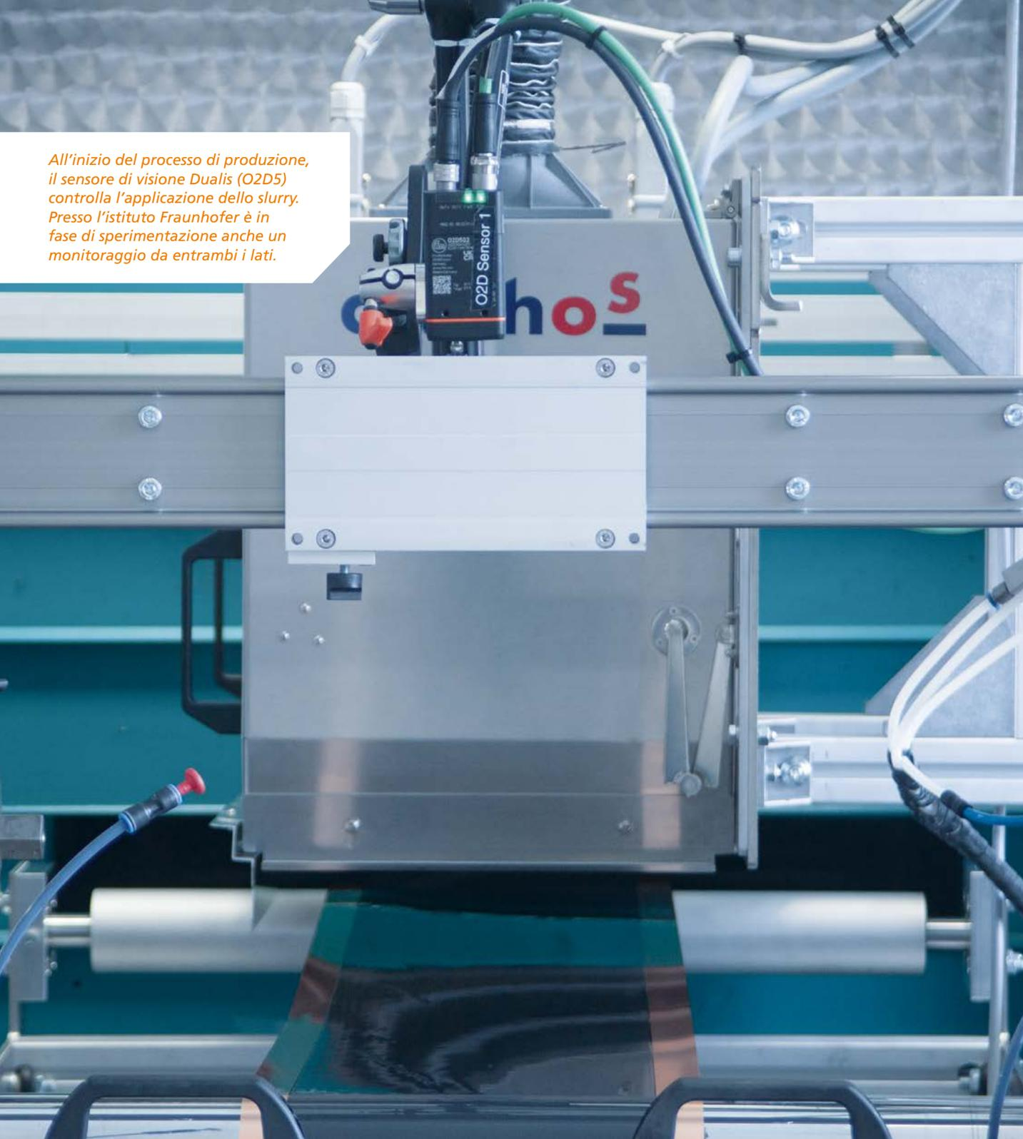
All'inizio del processo di produzione, il sensore di visione Dualis (O2D5) controlla l'applicazione dello slurry. Presso l'istituto Fraunhofer è in fase di sperimentazione anche un monitoraggio da entrambi i lati.
