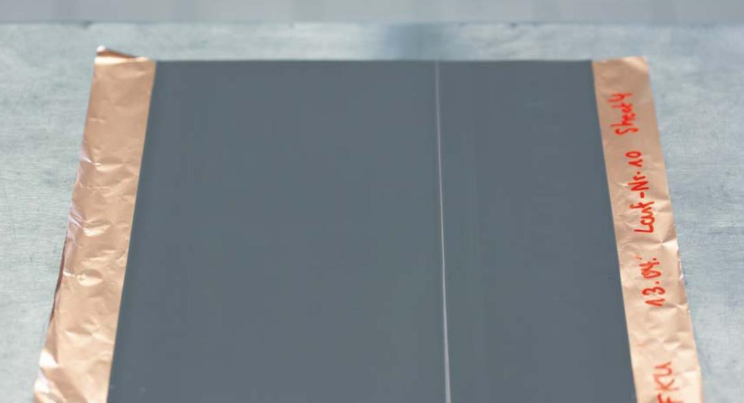
Le aree omesse nell'applicazione dello slurry causano scarti di produzione e devono essere identificate. Il sensore di visione Dualis di ifm segnala questo errore e contribuisce così a ridurre al minimo gli scarti di produzione.
