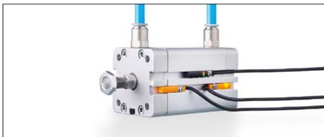
Einer statt zwei Sensoren: Am Kurzhubzylinder genügt nun ein IO-Link-Zylindersensor (obere Nut) statt wie bisher zwei herkömmliche Sensoren (untere Nut), um beide Endlagen zu erfassen.
