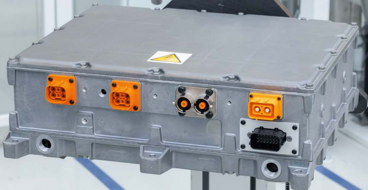
Cargador de a bordo ED3 completamente montado.
