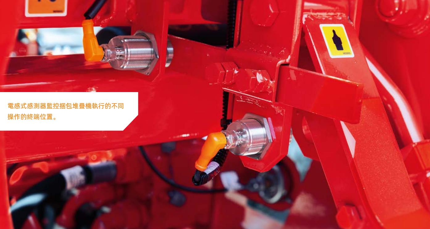
電感式感測器監控捆包堆疊機執行的不同操作的終端位置。
