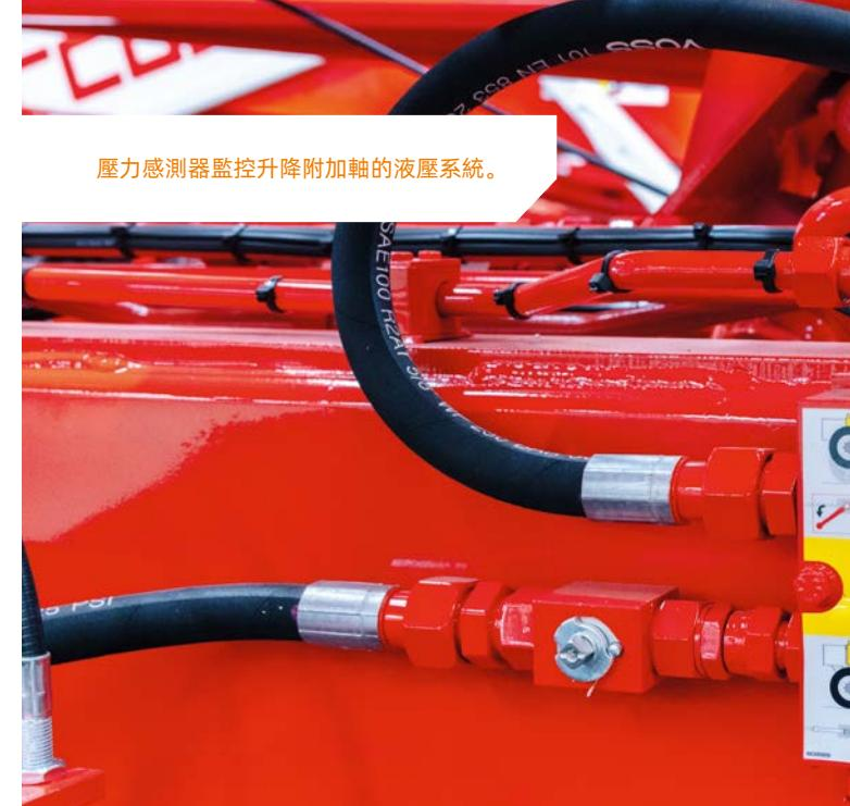
壓力感測器監控升降附加軸的液壓系統。
