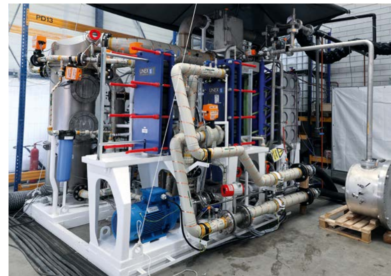
El propulsor de hidrógeno K2, desarrollado por Koedood y Kooiman, en fase de prueba poco antes de su montaje.
