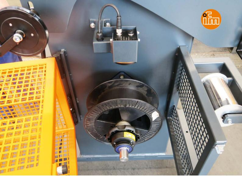
Der leere Spulenkörper reflektiert deutlich weniger Licht als der Draht. Der Sensor signalisiert "Kein Draht vorhanden".
