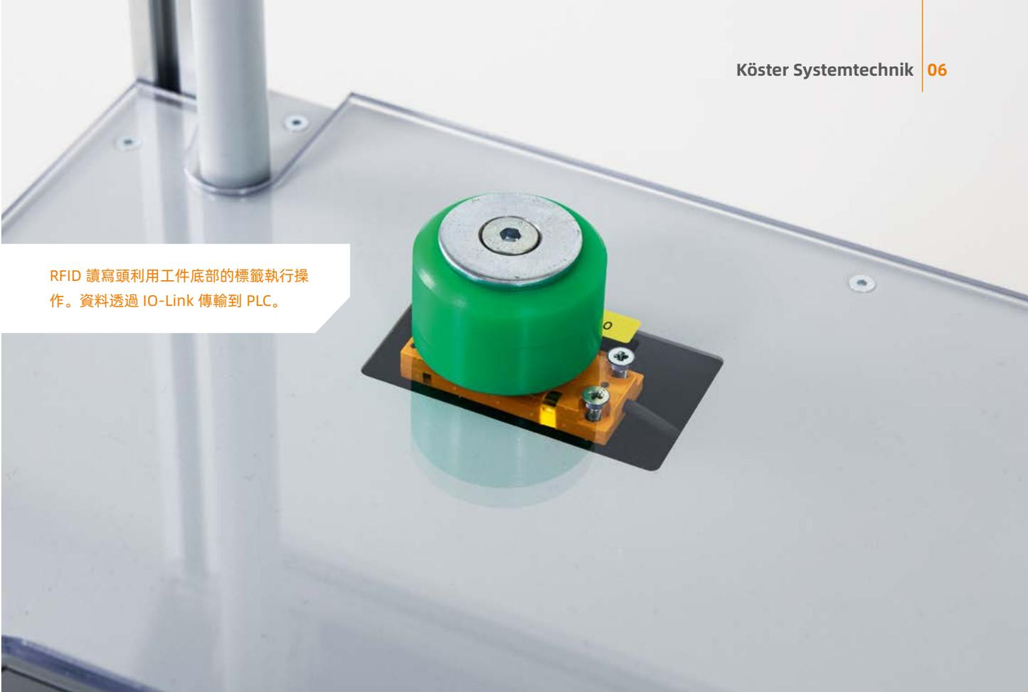
RFID 讀寫頭利用工件底部的標籤執行操作。資料透過 IO-Link 傳輸到 PLC。
