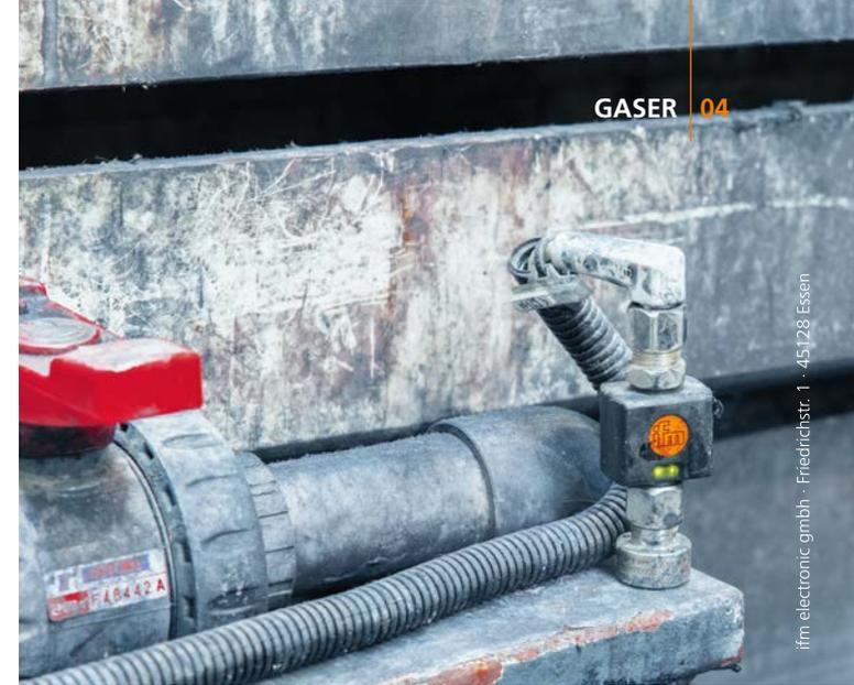
*Le capteur de température, le boîtier de contrôle et le câble résistent aux conditions environnementales sévères du processus d'anodisation.*
