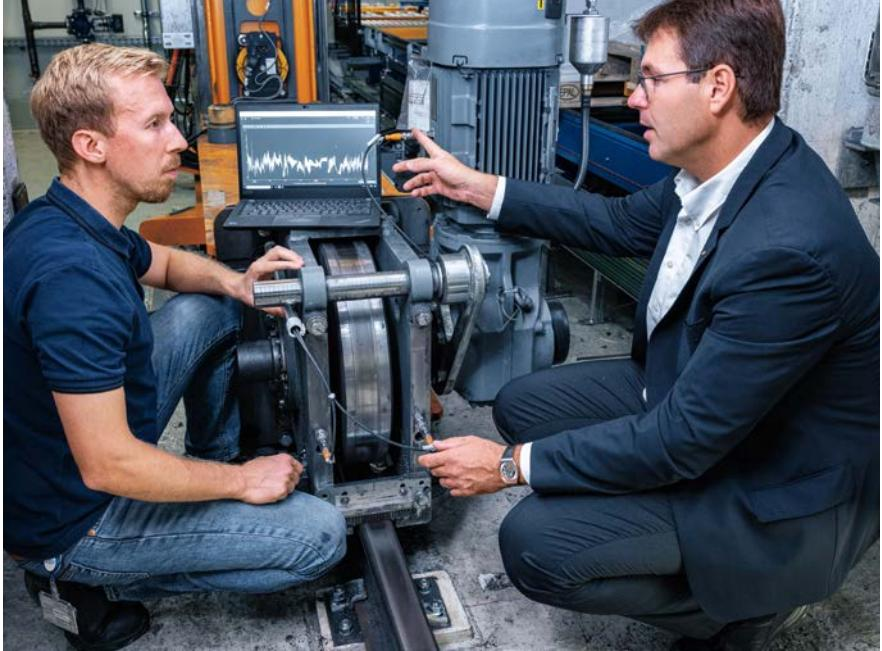
*Le logiciel de diagnostic moneo interprète les données vibratoires et déclenche une alarme en cas de dépassement des seuils. Les composants peuvent ainsi être parfaitement alignés et ajustés sur site.*
