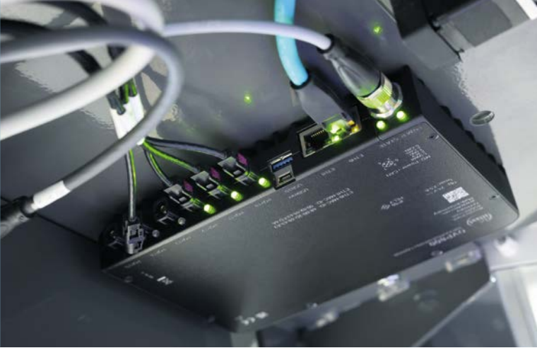
O3Rシステムのコアとなる高性能画像処理ユニット (VPU)。最大6台のカメラを接続できます。
