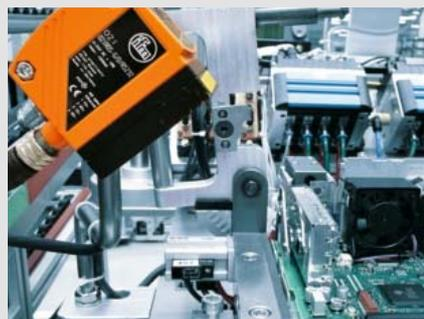
Il dispositivo compatto viene installato con il rispettivo set di montaggio e collegato al sistema di controllo (PLC) tramite l'interfaccia di processo. La parametrizzazione si esegue tramite cavo Ethernet usando un PC standard.
