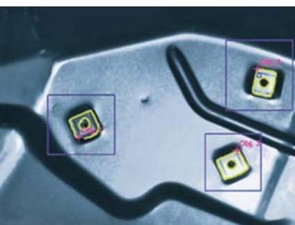
Controllo della presenza nel montaggio automatizzato: in quest'applicazione vengono posizionati tre fermagli su un pezzo della carrozzeria. Grazie al monitoraggio dei contorni di vari fermagli è possibile identificare i pezzi errati. Queste applicazioni che potrebbero essere risolte in alternativa utilizzando una serie di sensori ottici possono essere realizzate e controllate, in modo semplice e affidabile, con un unico sistema.
