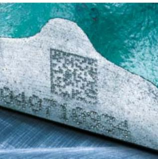
Il lettore multicode di ifm rileva una moltitudine di codici 2D e 1D nonché testo. Il codice 2D standard può essere applicato in modi diversi: stampato su carta, inciso a laser oppure bulinato su una superficie metallica.
