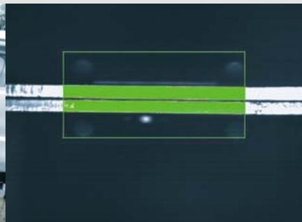
Il sensore per il controllo dei pixel controlla la presenza o la posizione di giunti saldati, punti saldati o sezioni con diversi gradi di blu a causa dell'alta temperatura durante la saldatura. Vengono rilevati anche i materiali applicati in modo irregolare come colla o grasso.
