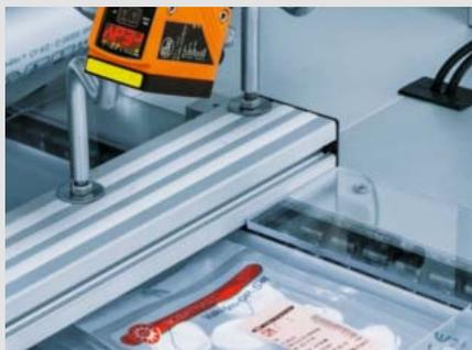
Un esempio applicativo: in base al codice Data Matrix, il lettore multicode rileva tamponi di cotone, confezionati in modo igienico, al loro passaggio su un nastro trasportatore.
