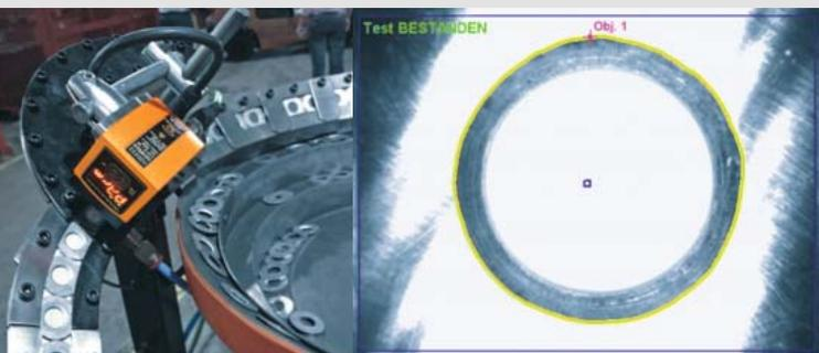
Su impianti di alimentazione automatizzati come ad esempio i vibrotrasportatori, il sensore di visione O2D controlla la corretta posizione di piccoli pezzi; i pezzi difettosi vengono scartati.
