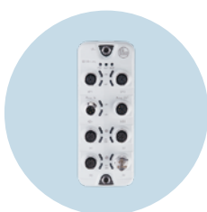
Maestros IO-Link Maestros de campo para utilización en zonas asépticas
