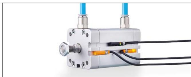
Un detector en lugar de dos: en los cilindros de carrera corta, ahora es suficiente con un detector IO-Link para cilindros (ranura superior) para detectar las dos posiciones finales, en lugar de los dos detectores convencionales (ranura inferior) que se necesitaban anteriormente.
